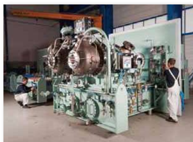
DFDE機関LNG船向け Cryostar社製4ステージ・ガスコンプレッサー
