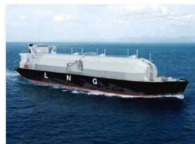
連続タンクカバー型の球形タンク方式LNG船 「さやえんどう」 【提供写真：三菱重工業(株)長崎造船所】
